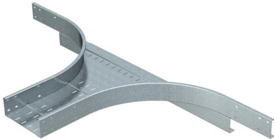
Derivação simples para montagem horizontal. Para todos os caminhos de cabos para grandes vãos com altura lateral 110 mm. Para uma maior estabilidade, devem ser colocados apoios sob os acessórios de montagem.
