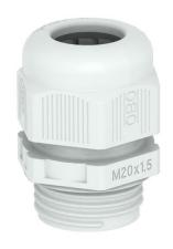
Bucim com rosca de ligação métrica em design de porca de capa, para caixas de derivação, caixas, armários de distribuição no sector privado e industrial. Com alívio de tensão e rebordo de vedação integrado testados de acordo com a DIN EN 62444. Classe de proteção IP68. Aplicável de -20 °C a +65 °C. Inclui contraporca.
