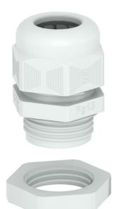
Bucim com rosca de ligação PG em design de porca de capa, para caixas de derivação, caixas, caixas de distribuição no sector privado e industrial. Com alívio de tensão e rebordo de vedação integrado testados de acordo com a DIN EN 62444. Classe de proteção IP68. Aplicável de -20 °C a +65 °C. Inclui contra-
