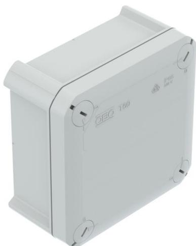
Caixa de derivação para conectar cabos em áreas interiores e áreas exteriores protegidas. Forma quadrada sem entradas. Adequado para a montagem na parede / teto e para a montagem em suportes para caixas de derivação. Com opção de fixação interna e montagem através de parafusos nos cantos. Tapa com fecho rápido, pode ser selada a chumbo. Fabricada em materiais resistentes aos raios UV e livres de halogéneo.
