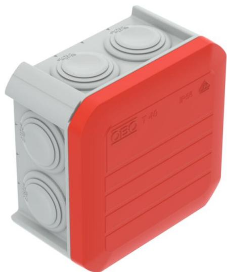
Caixa de derivação para conectar cabos em áreas interiores e áreas exteriores protegidas. Forma quadrada com buçins cónicos nas laterais e entradas quebráveis na base. Adequado para a montagem na parede / teto e para a montagem em suportes para caixas de derivação. Com opção de fixação interna. Com tampa de aperto fixa. Fabricada em materiais resistentes aos raios UV e livres de halogéneo.
