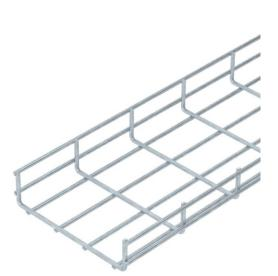
Caminhos de cabos em varão electrosoldado com altura de 55 mm. A largura de malha é de  $50 \times 100$  mm. Atenuação da blindagem magnética sem tampa 15 dB, com tampa 25 dB.
