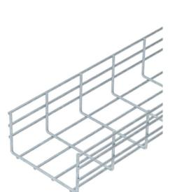
Caminhos de cabos em varão electrosoldado com altura de 105 mm. A largura de malha é de  $50 \times 100$  mm. Atenuação da blindagem magnética sem tampa 15 dB, com tampa 25 dB.
