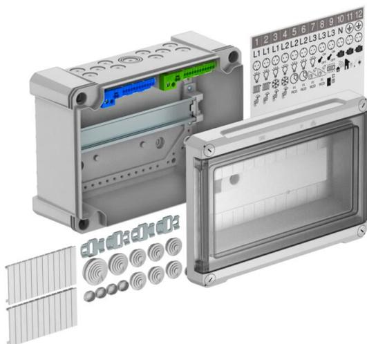
Quadro de distribuição com régua de bornes para montagem à superfície, para sub-distribuição de energia em área interior e exterior, de acordo com a IEC 439-3. Com calha DIN de 35 mm pré-montada. Tipo de proteção IP66 e grau de proteção IK06. Tampa transparente para aparafusar, com recorte.
