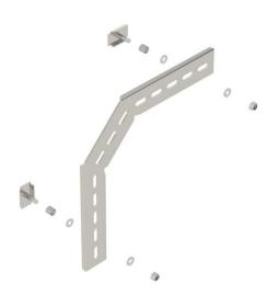
Perfil de montagem a 90°, vertical, para caminho de cabos em varão C e GR-Magic com 55 mm de altura lateral. Com 2 peças de aperto do tipo KS 23/35. Inclui união para a criação de ângulos de 45°.
