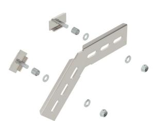
Perfil de montagem a 45°, vertical, para caminho de cabos em varão C e GR-Magic com 55 mm de altura lateral. Com 2 peças de aperto do tipo KS 23 35. Inclui união para a criação de ângulos de 45°.
