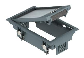
Tampa de encastramento com pega para até 3 aparelhos Modul 45 em um suporte universal UT3, utilização em sistemas de calhas de pavimento em interiores.
