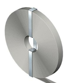
Cinta de aperto galvanizada para uma fixação universal, ligeira, em rolo de 100 m. Espessura 0,5mm.
