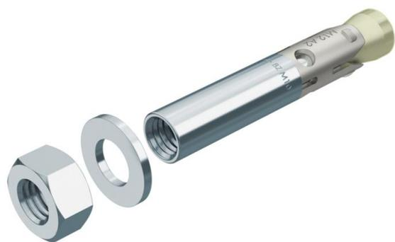
Perno de ancoragem BZ-IG com rosca interna para ancoragem de médias e grandes cargas, tanto em betão armado como não armado. O perno de ancoragem une as cargas elevadas permitidas com pequenas distâncias entre margens e eixos. Não é necessária uma reenrância das perfurações.
