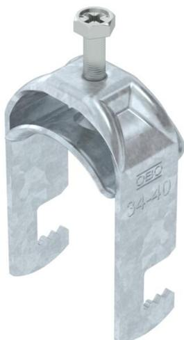
Abraçadeira BBS tipo F, placa de pressão metálica com arestas arredondadas para proteção de cabos. Para montagem vertical e horizontal de 1 cabo individual em ferros planos. Com parafuso simples na placa de pressão, cabeça de parafuso hexagonal universal tam. 10, com fenda e fenda em cruz. Adequado para montagem em áreas interiores e exteriores. Recomenda-se o uso de uma contraplaca.
