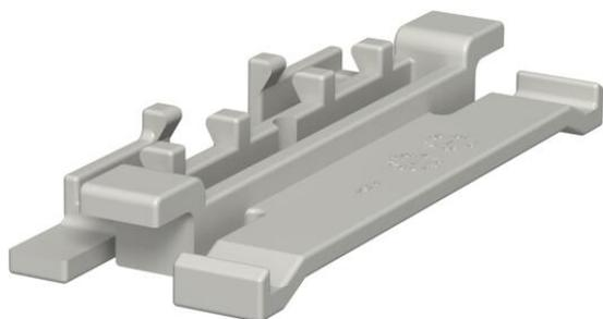
Agrafos para um assentamento simples dos cabos na calha WDK. O agrafos pode ser deslocado em todo o comprimento da calha. O agrafos é encaixado num lado e colocado virado para a frente. Deste modo, é possível uma abertura de 30°, sendo o assentamento dos cabos mais fácil.
