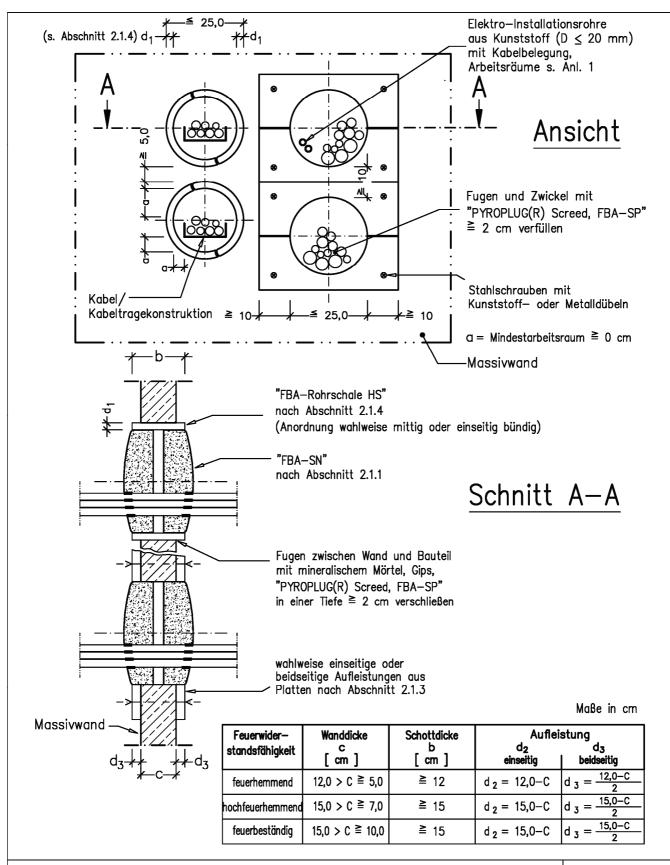
Feuerwiderstandsfähige Abschottung für elektrische Leitungen "PYROPLUG Peg"
