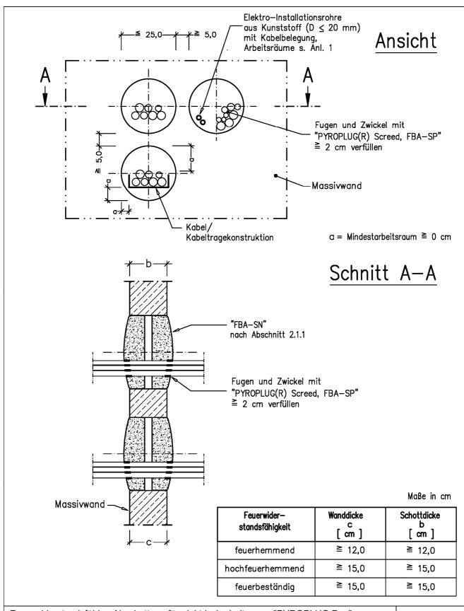
Feuerwiderstandsfähige Abschottung für elektrische Leitungen "PYROPLUG Peg"
