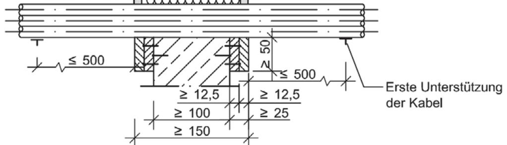
Variante 2 - 100 mm Schottdicke mit Wickel an den Kabelbündeln
